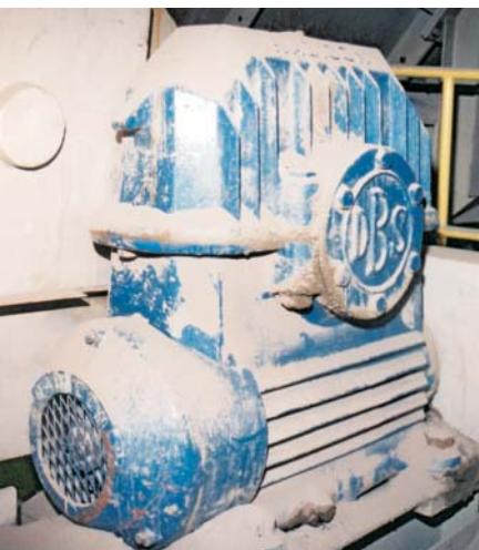
смазки на элементах во время запуска. Подобное происходит при эксплуатации в агрессивных средах, как с данной коробкой передач на фотографии ниже. Здесь проблему составляет абразивная пыль являющаяся неотъемлемой частью при производстве кирпича. С помощью Belesta LC износ можно существенно уменьшить.
