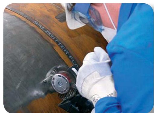
инновационный метод подготовки поверхности с помощью машинки MBX
